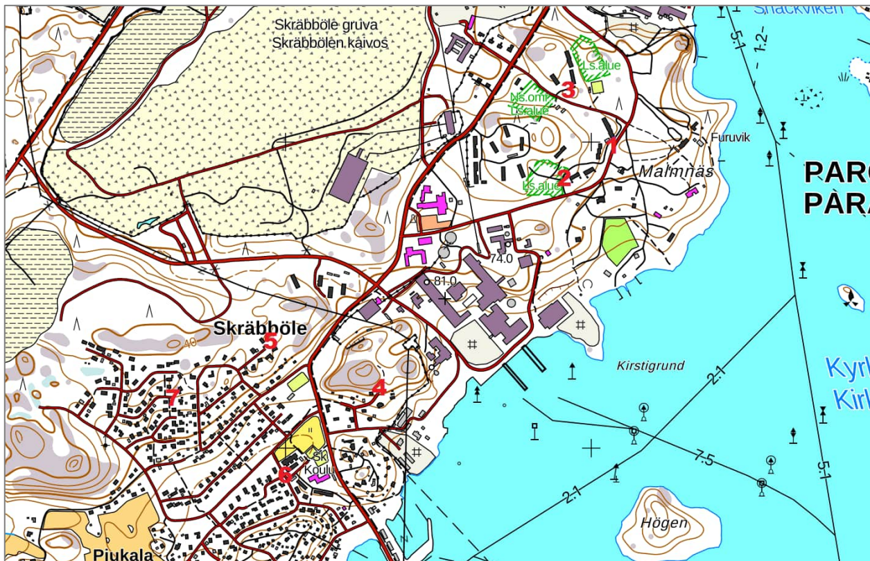
Kuva 1. Sementtitehdas on karttakuvan keskellä. Ympäristömelua mitattiin seitsemässä numerolla merkityssä paikassa tehdasalueen ympäristössä olevien asuinrakennusten läheisyydessä.
