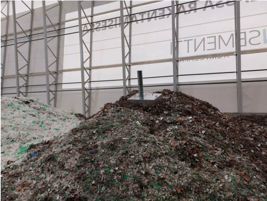
Kierrätyspolttoaine (SRF). Näytteenottopaikka 1. Kuvassa näytteenottohuuva.
